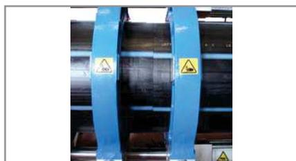
5. Vérifier l'alignement, contrôler le parallélisme entre les extrémités des tubes à souder et contrôler le désalignement (tolérance maximum de 10% de l'épaisseur du tube).
