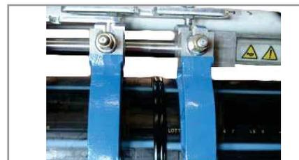
9. Augmenter progressivement la pression (rampe de pression) de zéro à la pression requise p1, dans un temps t4 et la maintenir pendant un temps t5. Laisser refroidir la soudure dans cette position, arrêter la pression p1 ou desserrer les colliers. Après le temps de refroidissement desserrer les colliers et retirer le tube de la machine.
