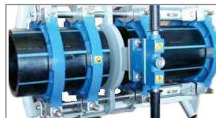
6. Nettoyer les faces de la plaque à souder avec de l'isopropanol (alcool). Vérifier avec un thermomètre à contact que la température de la plaque se situe entre 210-225°C. Vérifier la pression exercée et l'enregistrer sur la carte de soudure. Calculer P1, la pression pour la formation initiale du cordon (pression de soudage indiquée + pression de déplacement) et noter sur la carte.
