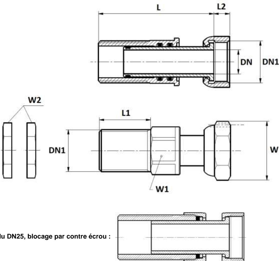
A partir du DN25, blocage par contre écrou :
