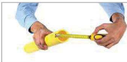
1. Mesurer le diamètre du tube.
