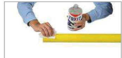
6. Nettoyer la zone de soudage avec un liquide approprié.
