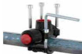
Posez le T-plus sur le tube et fixez-le avec quatre boulons. Les modèles à partir de 1½" sont fournis avec des écrous à encliqueter; le boulon est encliqueté puis vissé.
