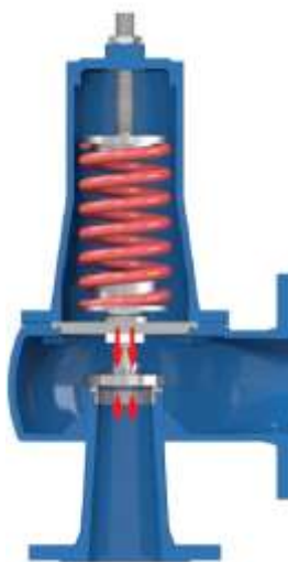
Soupape complètement fermée (pression statique)
